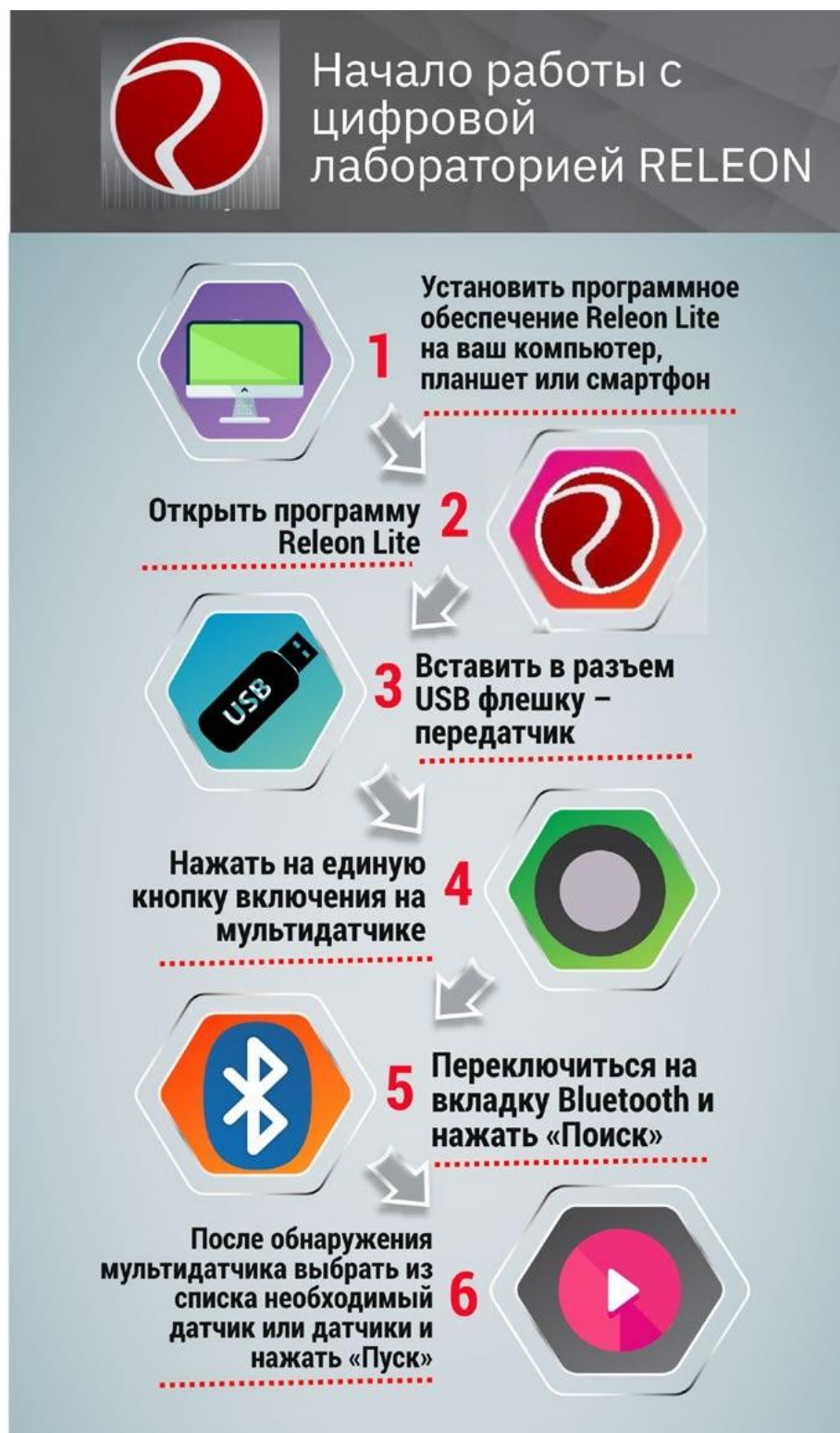
Рис. 6. Алгоритм работы с программным обеспечением Releon Lite
