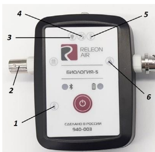
Рис. 2. Мультидатчик по биологии: 1 – температура растворов, 2 – электропроводимость, 3 – освещённость, 4 – относительная влажность воздуха, 5 – температура окружающей среды, 6 – рН
