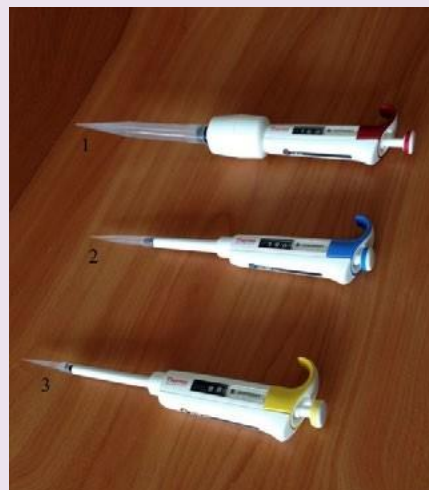
Рис. 5. Пипетки дозаторы одноканальные переменного объёма: 1 — 1—10 мл; 2 — 100—1000 мкл; 3 — 10—100 мкл.
