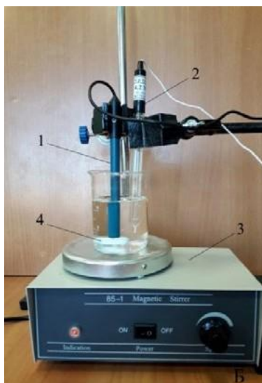
Рис. 2. Установка для определения концентрации (активности) хлорид-ионов в растворе.
